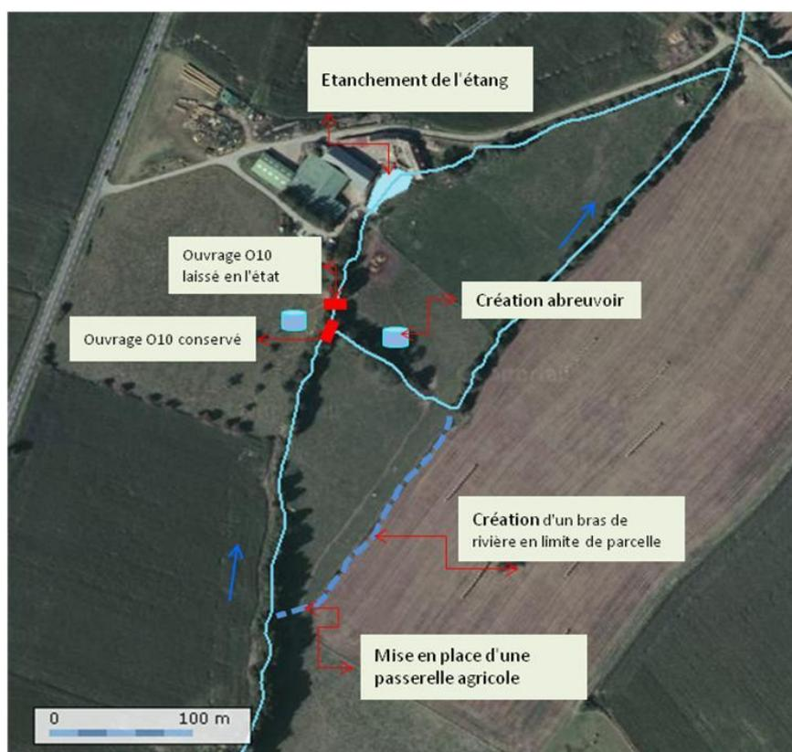
Figure 26 : Localisation des interventions sur l'ouvrage O9
